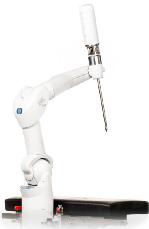
Für präzise Manipulationsaufgaben ist alternativ ein positionsgeregelter Betrieb des Roboters möglich. Die Spezialisierung des vielseitigen Leichtbauroboters MIRO erfolgt über seine Instrumentierung sowie anwendungsspezifische Software.
