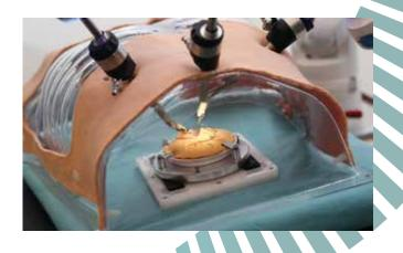
wie das Telechirurgiesystem MiroSurge<sup>®</sup>, das je nach Anforderung aus zwei oder mehreren MIRO-Roboterarmen besteht. Diese Entwicklung war die Grundlage eines aktuellen Markterfolges: Technologische Komponenten des MiroSurge-Systems wurden an das Unternehmen Medtronic lizenziert und finden sich heute in dem neuen Hugo™ RAS-System (roboticassisted surgery) wieder.
